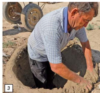
Рис. 1. Изготовление тандыра в яме с помощью лоскутного налепа. Мастер Шаукет Исаев, с. Жуйнек (Казахстан). Фото С. Рахимжановой.
