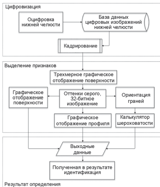
Рис. 1. Схема исследования шероховатости поверхности.
