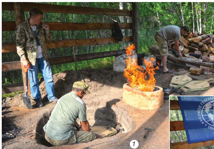
Рис. 6. Процессы прогрева печи (1), загрузки шихты (2) и верхнего дутья (3). Эксперимент автора 2017 г.
