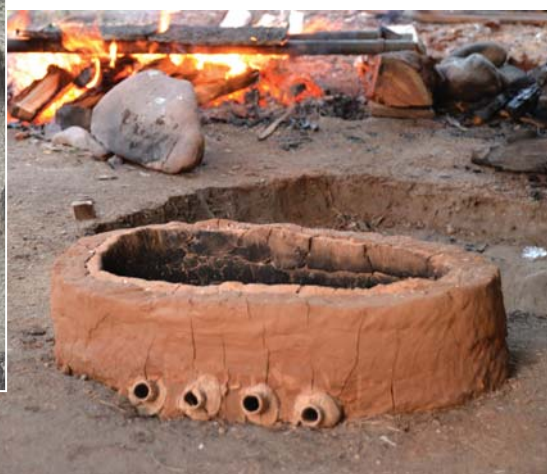
Рис. 5. Реконструированная железоделательная печь. Эксперимент автора 2017 г.
