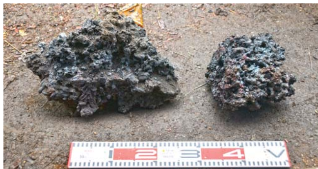
Рис. 7. Монолит конгломерата с включениями сыродутного железа. Эксперимент автора 2017 г.
