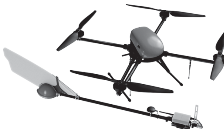
Рис. 4. Комплекс Геоскан 401 Геофизика для высокоточной аэромагнитной съемки.
