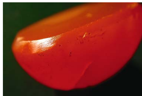
Рис. 5. Следы обработки фаски крупнозернистым абразивом.
