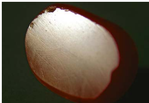
Рис. 3. Следы формообразующей шлифовки и характер полировки основания кабошона.
