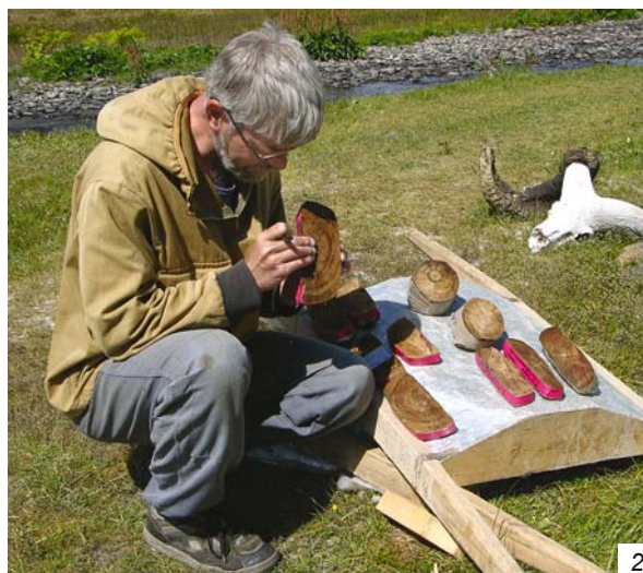
Рис. 6. Отбор образцов для дендрохронологического анализа. 1 – изготовление поперечного спила с бревна; 2 – оценка качества отобранных образцов.
