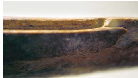
Рис. 8. Углубление конической формы, высверленное на крае паза изделия 1.
