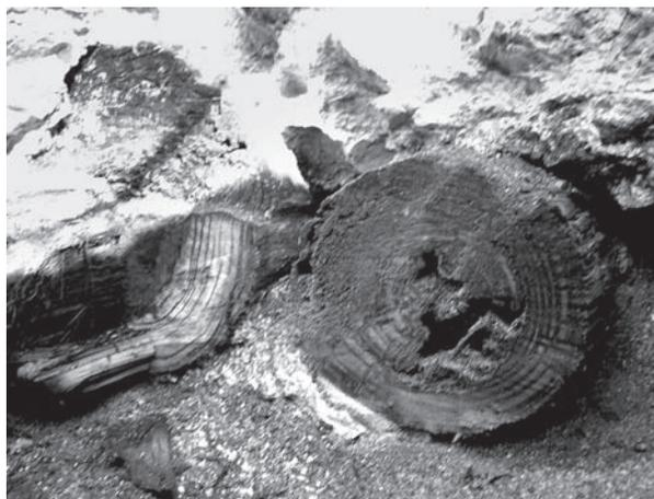
Рис. 1. Торцы бревен лежни после отпиливания образцов древесины.
