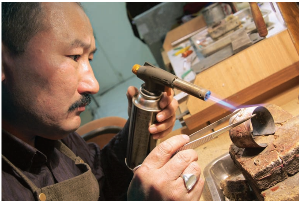
6. Б. Алибай за работой над браслетом (пайка декоративной фигурной накладки).
