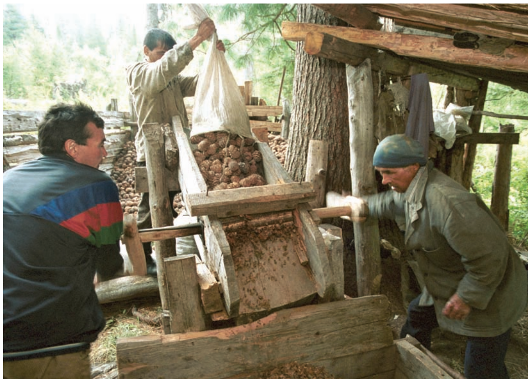
9. Для шелушения шишек используют мельницы с металлическим шипованным валом, установленным в деревянный короб.
