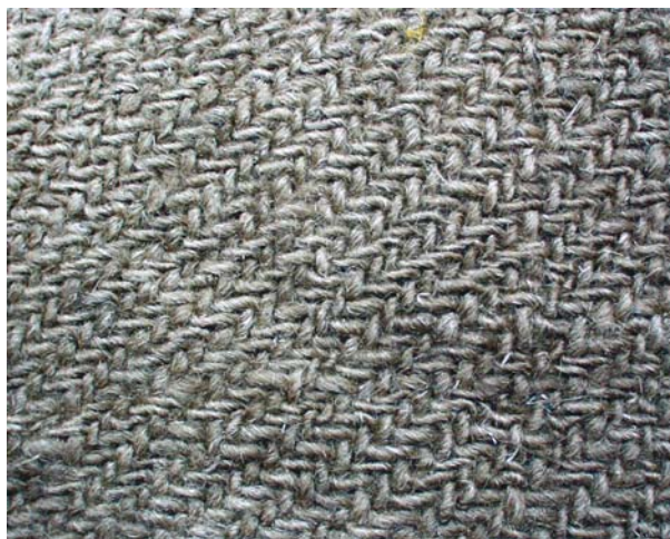
Рис. 7. Фрагмент толстой плотной ткани саржевого переплетения (саржа 2/2) (обр. МГ-03/316).
