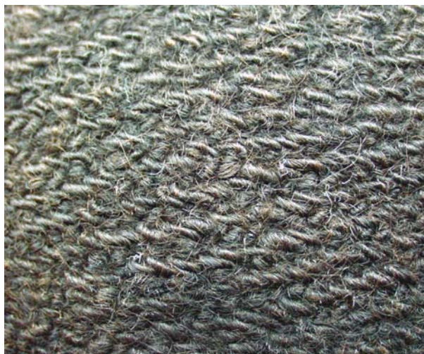
Рис. 8. Фрагмент плотной толстой ткани саржевого переплетения (обр. МГ-03/80).
